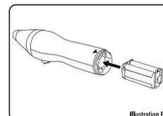
5. Lorsque les flèches sont alignées, insérez le compartiment des piles dans le manche (Illustration E).
