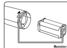
4. Alignez la flèche bleue du manche avec celle sur le compartiment des piles (illustration D).
