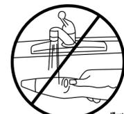
3. Le manche ne doit jamais être en contact avec de l'eau. Essayez-le avec un linge humide (Illustration N).
