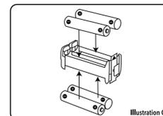
3. Insérez 4 piles AA en respectant les polarités indiquées dans le (Illustration C).
